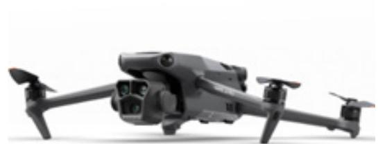
**Figure 13** : Drone Mavic 3 Pro avec les 3 capteurs et focales associées différentes. Crédit photo DJI
