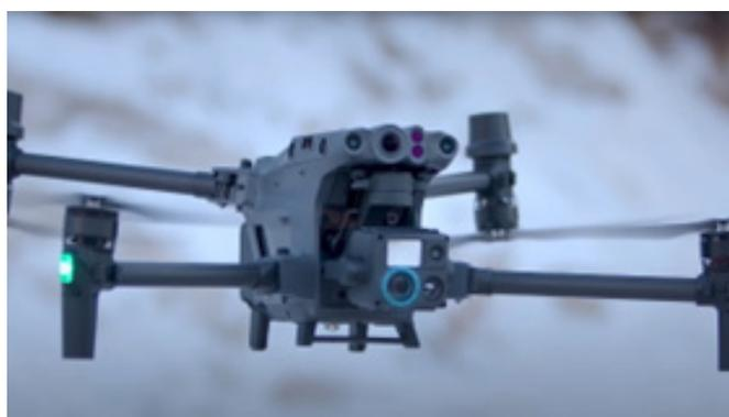
Figure 16 : Drone Matrice 30T équipé d'un capteur télémètre laser (capteur rectangulaire). Crédit photo DJI
