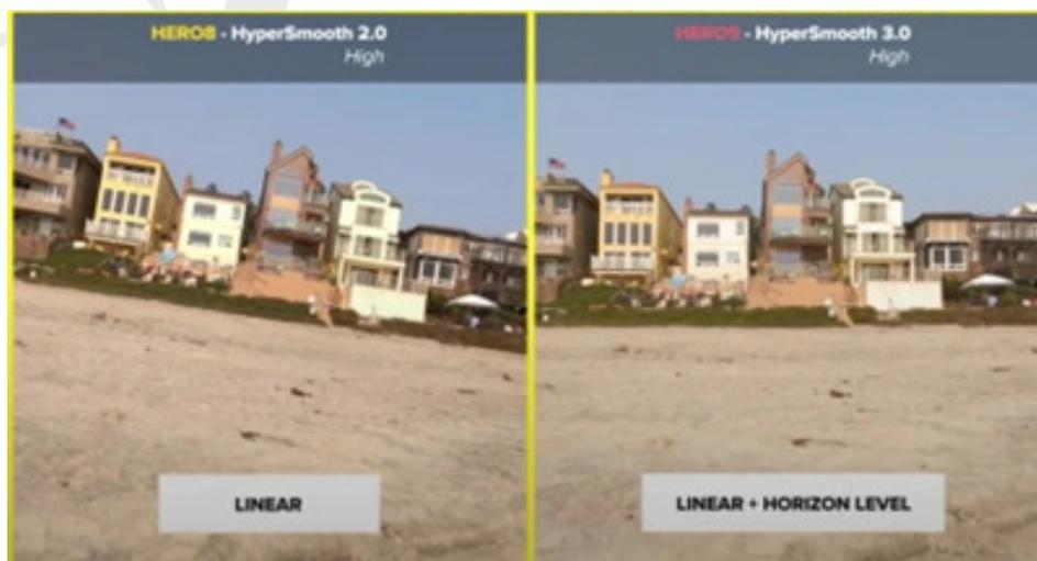
Figure 10 : Exemple de différence entre Stabilisation d'Horizon actif et non-actif, extrait de la vidéo d'Abe Kislevitz réalisé en 2020 : <https://www.youtube.com/watch?v=n5-BXQw2kJ4>
