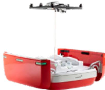
**Figure 5** : Schéma de Fotokite Sigma avec une liaison filaire et sa drone box. Source : fotokite.com
