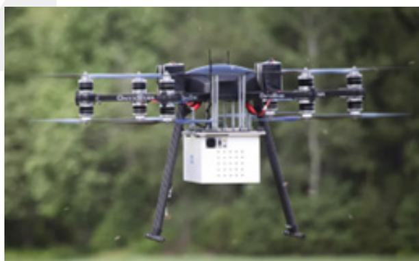
**Figure 20** : Drone équipé d'un capteur électronique qui sert à détecter les signaux électroniques. Source : altigator.com
