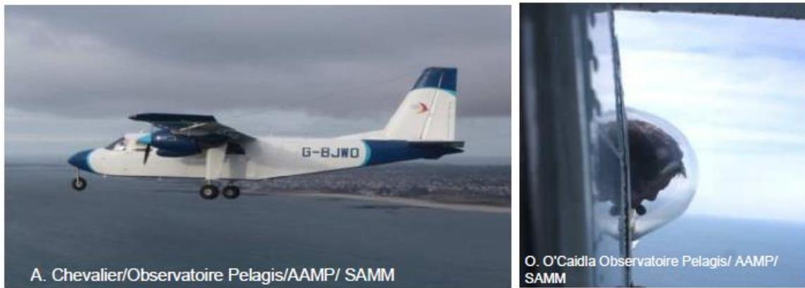
**Figure 8** : Avion à ailes hautes de type Britten Norman 2 utilisé pour les survols et son hublot bulle.
